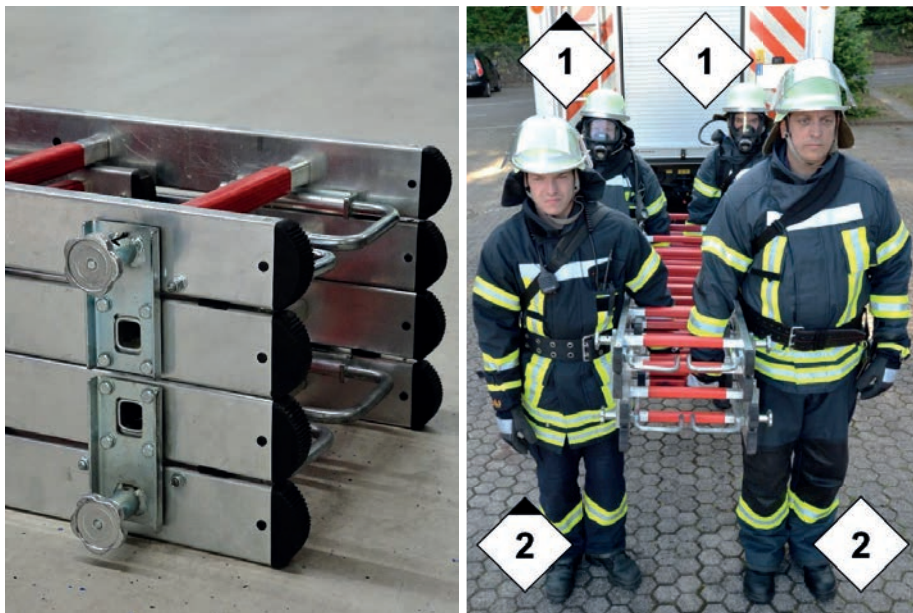
Abbildung 37: Trageweise der Multifunktionsleitern zur Anleiterstelle
