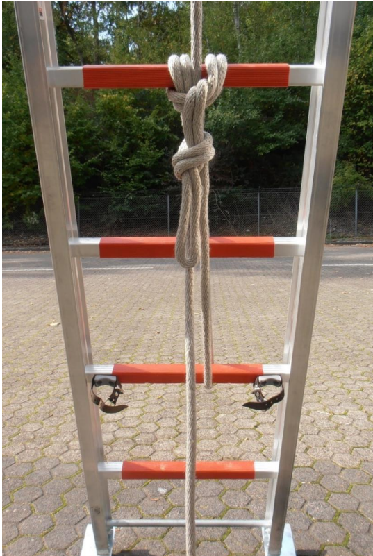
Abbildung 24: Sichern des Zugseils mit Mastwurf und Spierenstich
