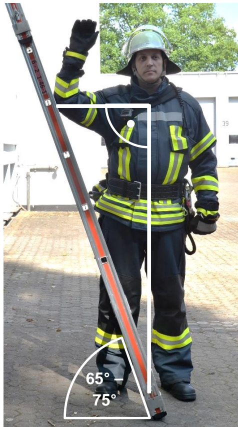
Abbildung 2: Überprüfen des Anstellwinkels
